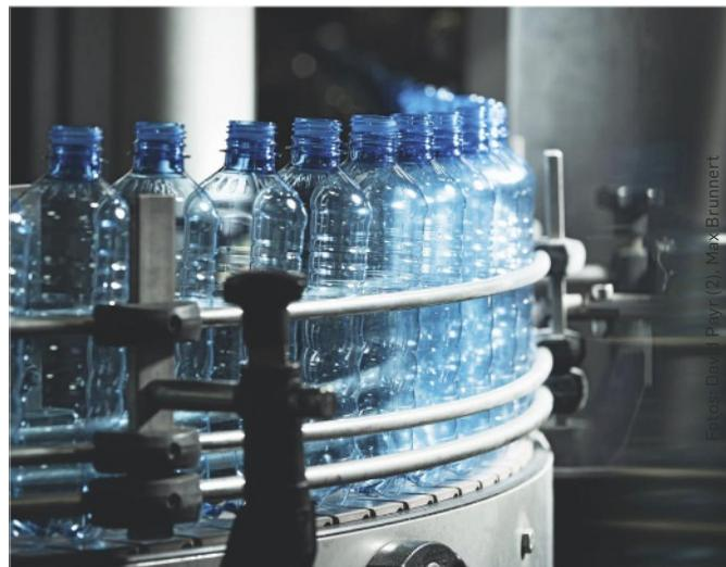
Erst die Fortentwicklung dieser Maschinen hat den globalen Plastikflaschenboom ermöglicht. Ein Umlauf dauert auf den modernsten Anlagen nur noch 1,3 Sekunden, ein Zwölftel der Zeit wie in den Pionierjahren. Damit können die Maschinen die zwölffache Masse produzieren.
